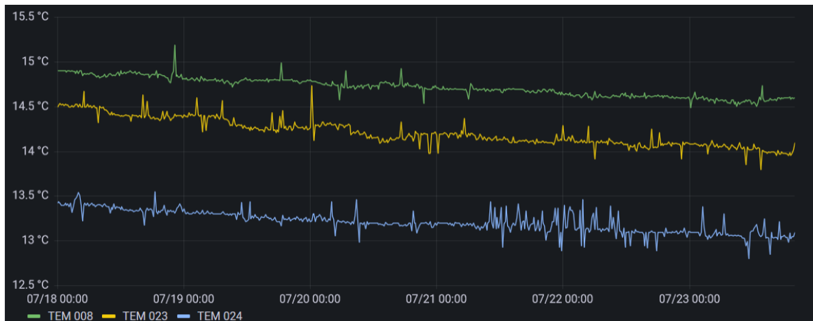
Abbildung 31: Temperaturwerte der Sensoren in der untersten Kollektorebene während des TRT-Betriebes
