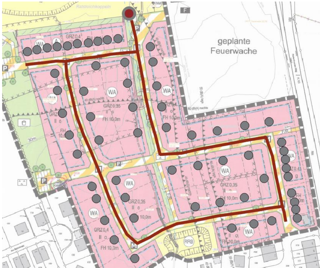
Abbildung 11: Darstellung der Netztopologie (rote Linie), der Gebäudeübergabestationen (graue Punkte) und der zentralen Einspeisung (roter Punkt mit grauer Umrandung)
