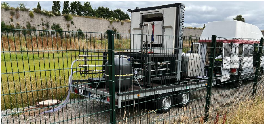
Abbildung 30: Mobiles TRT-Gerät im Einsatz (Quelle: Joseph Balda, FAU)
